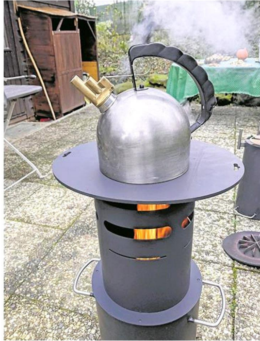
Rainer Sagawe ist fasziniert von der Idee der Pyrolyseöfen. Schnell ist das Teewasser warm – und übrig bleibt Pflanzenkohle, die in der Schubkarre gelagert wird oder direkt auf den Kompost wandert. FOTOS: HZS
